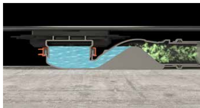
Постоянный сифонный затвор благодаря волнообразной форме
