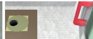
9. Нанесіть плитковий клей за допомогою шпателя з зубом 4x4 мм
