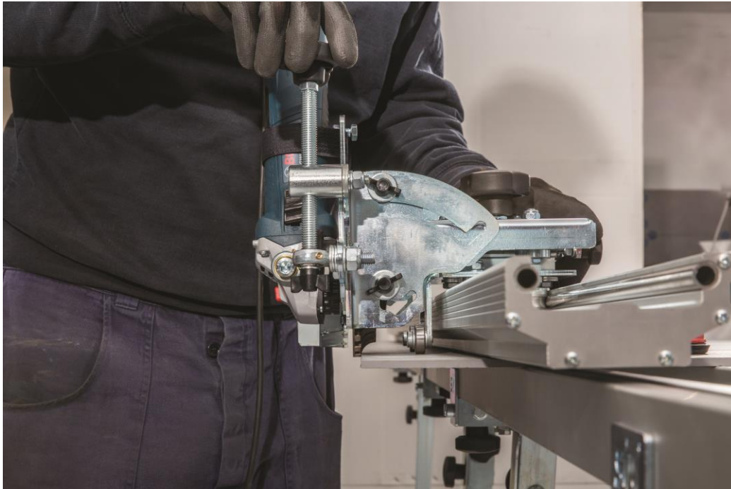
Fig. 6.3.6 regolazione altezza e esatta posizione della mola
